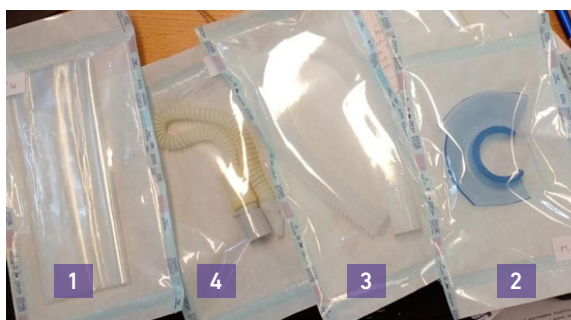
Foto 2. Muestras número 1, 4, 3 y 2 seleccionadas para determinación de residuo de óxido de etileno, etilenclorhidrina y etilenglicol residuales n° 1, 4, 3 y 2
